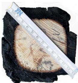
Abb. 22. Querschnitt KVH nach Brandbeanspruchung
