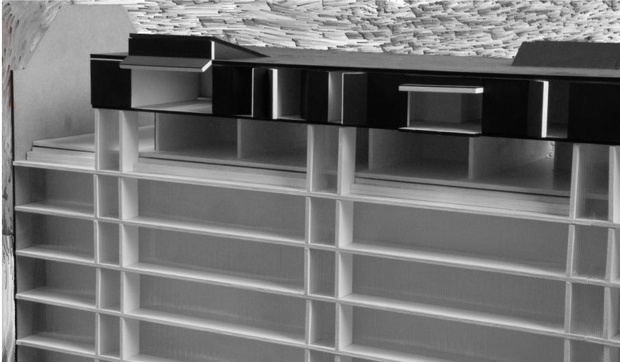
**Abb. 39.** Modell: Blick vom Innenhof auf die zweite Haut-Fassade mit Aufzugsschächten, Balkonen und den Dachaufbauten
