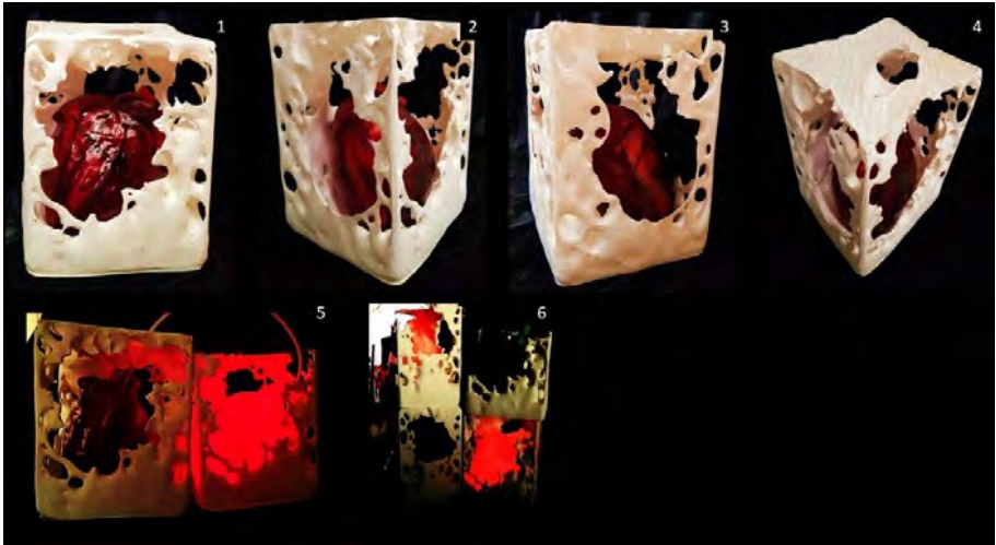
Abbildung 15. Das „Heart-Shelter“-Ziegelsystem. 1., 2., 3. und 4. zeigen verschiedene Ansichten des 3D-gedruckten „Heart-Shelter“-Ziegels, der seine knochenähnliche poröse Struktur aufweist, die durch algorithmische Modifikation des strukturellen Musters von trabekulärem Rinderknochen aus CT-Scans entwickelt wurde, und die feste Anordnung des Herz-Biobehälters innerhalb der maßgeschneiderten Höhle im Ziegel-Shelter zeigt, wo der Herz-Biobehälter leicht zu handhaben ist, um mit frischem biolumineszente Medium aufgefüllt zu werden, jedoch nicht aus dem Shelter entfernt werden kann, um dessen Verlust zu verhindern. 5. und 6. zeigen die MFC-Anordnung der Herz-Bioreaktoren innerhalb ihres Schutzes und veranschaulichen die leuchtende Biolumineszenz der Herzen in einem dunklen Raum bei einer Reaktionsaktivierungszeit von 3 Sekunden. Von den Autoren.
