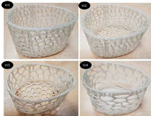
Abbildung 10. Die 3D-gedruckten Iterationen der Voronoi-Familie von Biocup-Entwürfen, erstellt von den Autoren.
