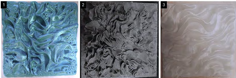
Abbildung 7. Designvarianten für die bioreceptiven Paneele, bei denen das Design durch die Anpassung feldbasierter Muster mit unterschiedlichen Wachstumsmustern variiert wird; zudem werden Farbe, Transparenz und Reflektivität des verwendeten PLA-Filaments im 3D-Druckprozess jeder dieser Designvarianten variiert. Von den Autoren.
