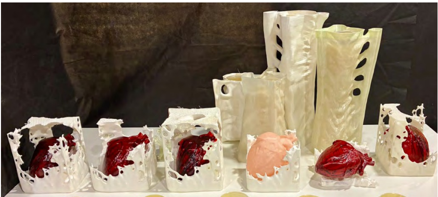
Abbildung 14. 3D-Druck und Farbgebung der „Urban Hearts“-Biobehälter und MFC-Kammern: verschiedene Maßstäbe der 3D-gedruckten Herz-Biobehälter. 1. Der 3D-gedruckte Herz-Biobehälter im städtischen Maßstab (40 x 40 x 50 cm) wurde mit dem Felix XL Pro Dual-Head-Drucker aus durchscheinendem rotem PLA gedruckt. 2., 3. und 4. zeigen den Herz-Biobehälter im Maßstab eines architektonischen Elements (20 x 20 x 20 cm), 3D-gedruckt aus durchscheinendem rotem PLA mit dem Felix Pro Dual-Head-Drucker und mit Lack (durchscheinendes Carmenrot und durchscheinend) versehen, um eventuelle Gussnähte zu verbergen und den realistischen Effekt von Herzkapillaren und Blut zu erzielen, der das menschliche Herz nachahmt. 5. und 6. sind zwei Ansichten des getrockneten „Urban Heart“-Bio-Containers auf einem 3D-gedruckten Ständer, der Teil des „Heart Shelter Brick“ ist. Unten: die „Urban Hearts“- und „Bone“-Bio-Container in der BioLumCity-Ausstellung. Von den Autoren.
