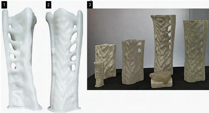
Abbildung 16. Der knochenförmige Biobehälter für biolumineszente Flüssigkulturen. 1. und 2. zeigen zwei Ansichten des Modells des knochenförmigen Biobehälters im Maßstab 1:10. 3. zeigt die 3D-gedruckten Modelle der Biobehälter im Maßstab 1:2 in verschiedenen Druckphasen und mit unterschiedlichen PLA-Filamenten, darunter durchscheinende, transparente und leuchtende Filamente. Das Foto stammt von der Ausstellung „Heart of Architecture“, die im Februar 2025 an der Universität Internacional de Catalunya in Barcelona stattfand. Von den Autoren.
